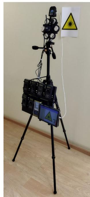
Рис. 4. Фотография специализированного стенда измерения энергетических характеристик отраженного излучения.
