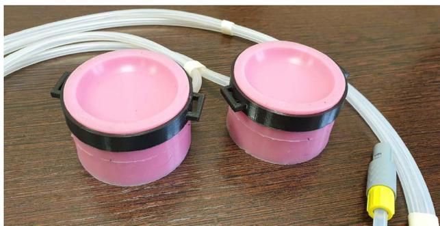
Рис. 2. Пьезокерамические датчики, используемые в исследовании
