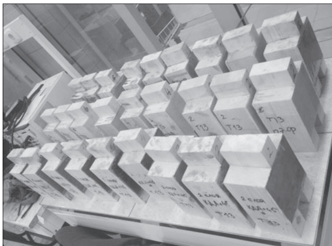
Рис. 3. Общий вид образцов соединения КМ-обклейка тип 1, 2 и 3 с обклейкой в 2, 4 и 6 слоев
