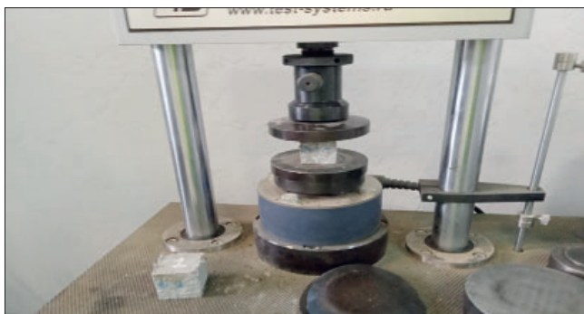
Рис. 5. Испытание бетонных образцов на сжатие Fig. 5. Compression testing of concrete samples
